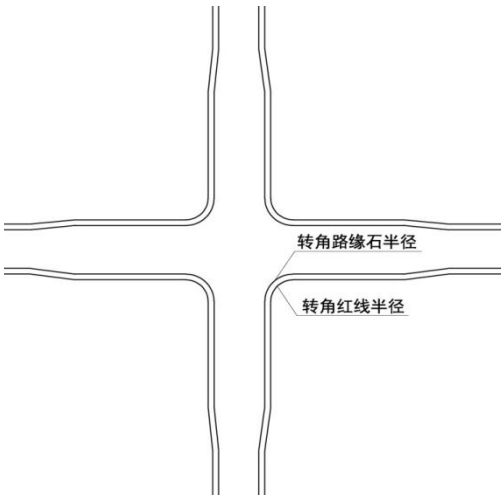
图1 转角路缘石半径与转角红线半径关系图
